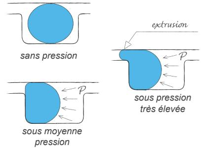
Diagramme d'extrusion d'un joint torique en fonction de la dureté du caoutchouc, du jeu et de la pression. Ces valeurs sont à relativiser pour les faibles diamètres de tore.
