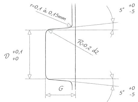
Dimensions des gorges pour un montage de type radial (piston / alésage) en utilisation dynamique.
