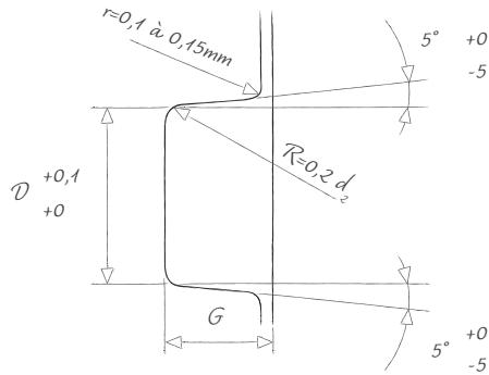
Dimensions des gorges pour un montage de type radial (piston / alésage) en utilisation statique
